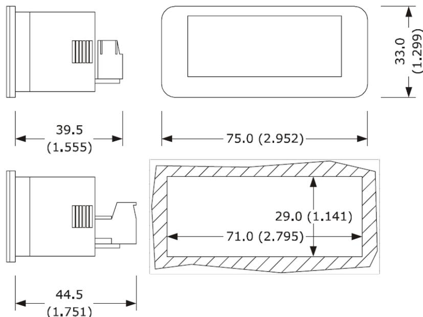
39.5 (1.555) - наибольшая глубина с встроенными винтовыми контактными группами;
